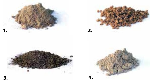
1. Terra diatomácea / 2. Cortiça / 3. Argila / 4. Cal Hidráulica Natural
