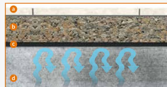
a Pavimentação b. Diathonite Betonilha c. WATstop d. Laje
