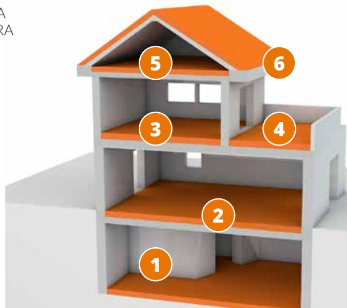
**Diafon** é o tapete insonorizante que, utilizado em combinação com a **Diathonite Betonilha**, permite isolar eficazmente o ruído de impacto no piso, criando um “pavimento flutuante”.
